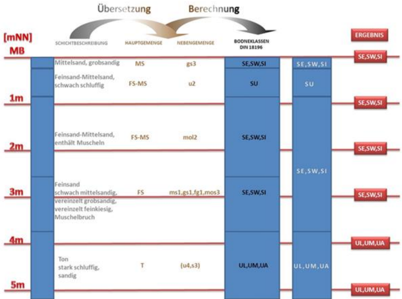
Abbildung 4: Übersicht zum Ablauf der Klassifikation von der Parametrisierung der Schichtbeschreibung bis zur Berechnung der geotechnischen Bodenklassen in 1-Meter-Intervallen
